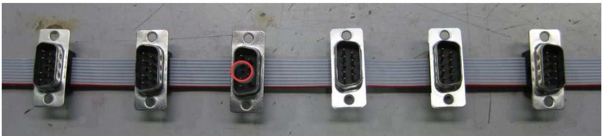
3. Abschlusswiderstände vorbereiten: 120Ω Widerstand zwischen Pin 2+7 und 4+9 D-Sub Stecker mit Lötkegel verwenden (Conrad 742066-05).
